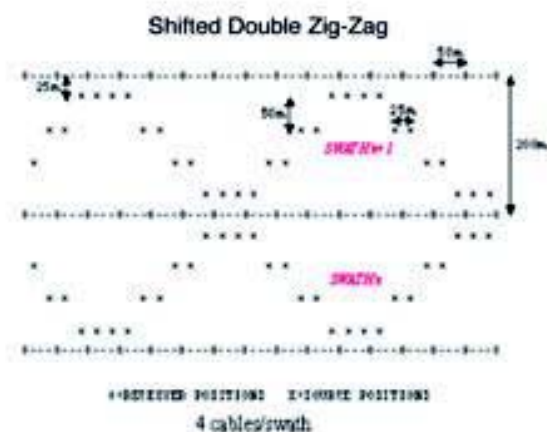
Рис. 12. Полевая расстановка «Сдвинутый двойной зигзаг» (x=источник, o=приемник).
