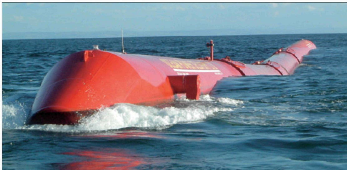
Рис. 3. Pelam — устройство извлечения энергии волн, принадлежащее компании Ocean Power Delivery, проходит испытания в море. Pelam поддерживается компанией Norsk Hydro. (Фотография приводится с разрешения ООО Ocean Power Delivery).
