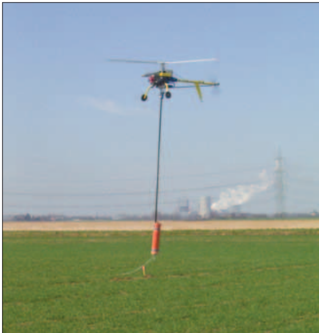
Figura 4 Vuelo autónomo de UAS durante el levantamiento aeromagnético cerca de Colonia.
