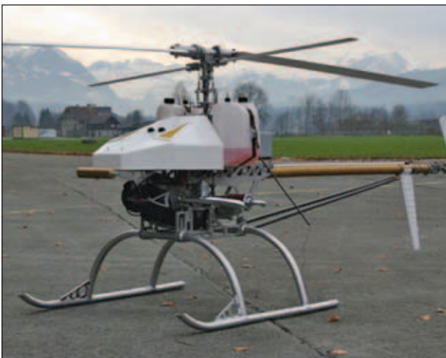
Figura 1 Scout B1-100, desarrollado por AeroScout, Suiza: Peso 43 kg; carga útil 15 kg.
