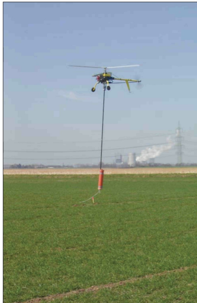
Рис. 4 Автономный полет БАК при аэромагнитной съемке близ Кельна.
