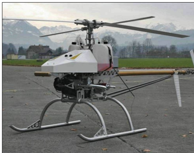
Рис. 1 Scout B1-100, разработанный компанией Aeroscout (Люцерн, Швейцария): вес 43 кг; грузоподъемность 15 кг.
